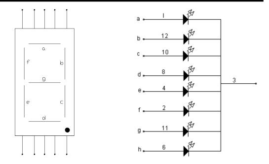
**b.-** Monte el siguiente circuito (no se olvide de conectar la resistencia de 100 ohmios para evitar deteriorar el display):
