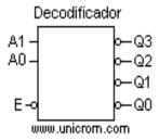
El decodificador es un dispositivo que acepta una entrada digital codificada en binario y activa una salida. Este dispositivo tiene varias salidas, y se activará aquella que establezca el código aplicado a la entrada.
