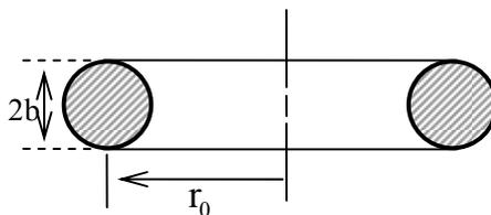
A continuación se muestra un corte transversal de la bobina toroidal.
