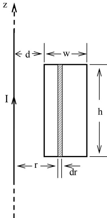
Para calcular la inductancia mutua entre la espira rectangular conductora y el alambre recto muy largo, de manera directa utilizamos la siguiente ecuación:
