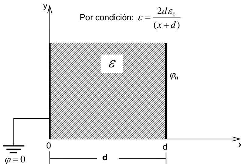
Como se observa en la figura, se trata de un capacitor plano con dieléctrico, y con una de sus placas conectada a tierra.
