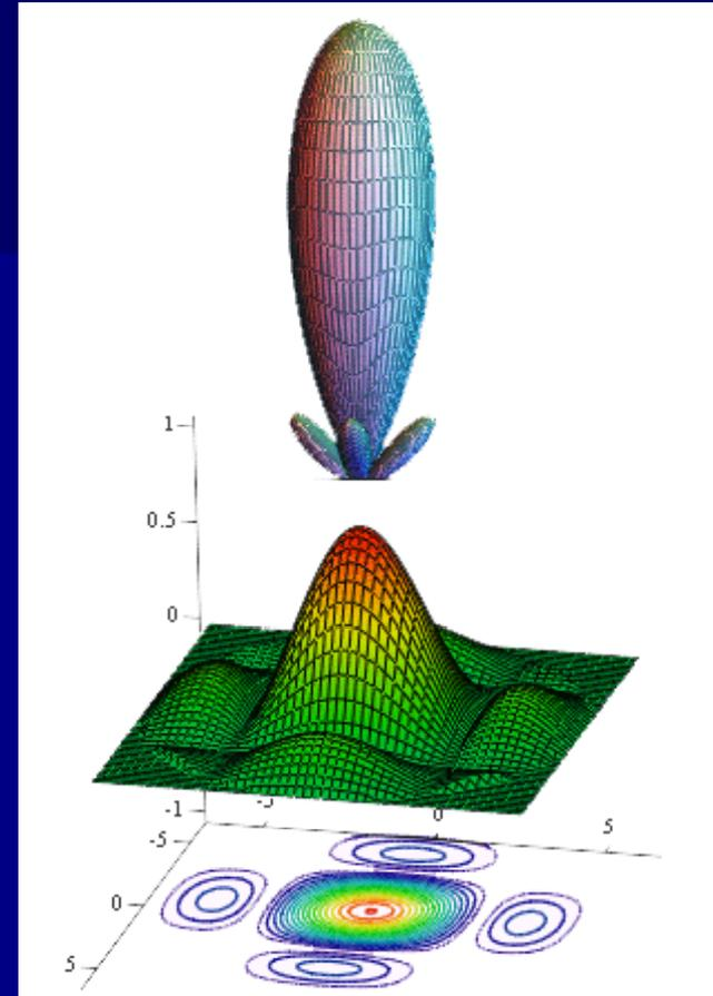
*Las gráficas corresponden a una antena bidimensional. En este caso se utiliza métodos de representación en forma de curvas de nivel o en forma de funciones tridimensionales.*
