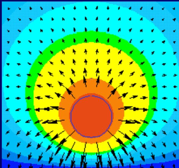
*La figura muestra la representación gráfica del campo vectorial correspondiente al campo eléctrico creado alrededor de una carga eléctrica positiva.*
