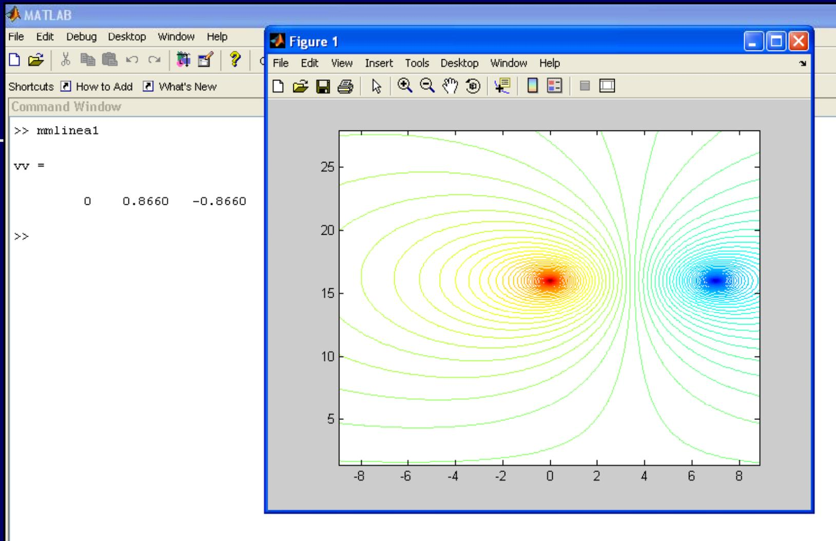
En la figura mostrada, las líneas cerradas representan las superficies equipotenciales correspondientes al CAMPO ESCALAR: POTENCIAL ELÉCTRICO alrededor de dos de las tres fases de una línea de transmisión de alta tensión de 60 kV, donde la fase S está a mayor potencial (0.8660: tensión por unidad) y por esa razón se observa esta fase de color rojo que indica un mayor potencial, mientras que la fase T, que tiene potencial negativo (-0.8660: tensión por unidad), se observa de color azul.
