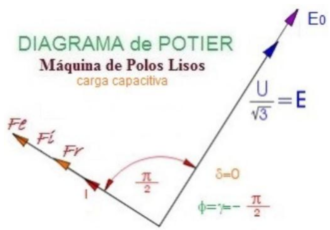
Figura16.- Diag Pottier- Carga capacitiva.
