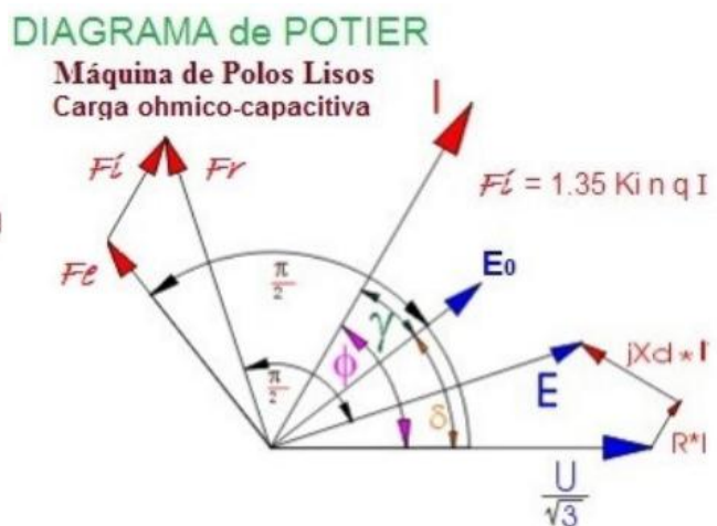
Figura15.- Diag Pottier- Carga RC.
