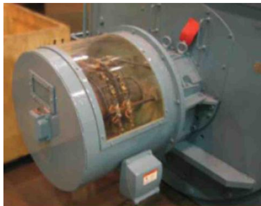
Figura 23.- Anillos colectores de excitación.
