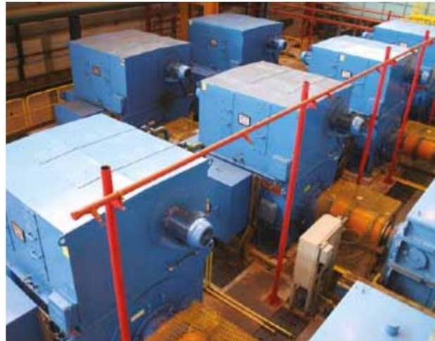
Motores sincrónicos SDL800, 3.000 kW, 3.100 V Aplicación: Laminadoras (siderurgia)
