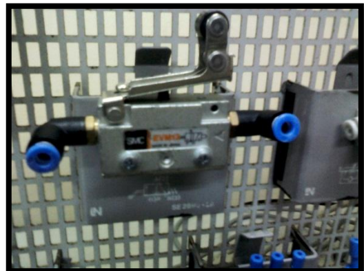
Válvula de 3/2 vías de accionamiento mecánico acompañada de una roldana.
